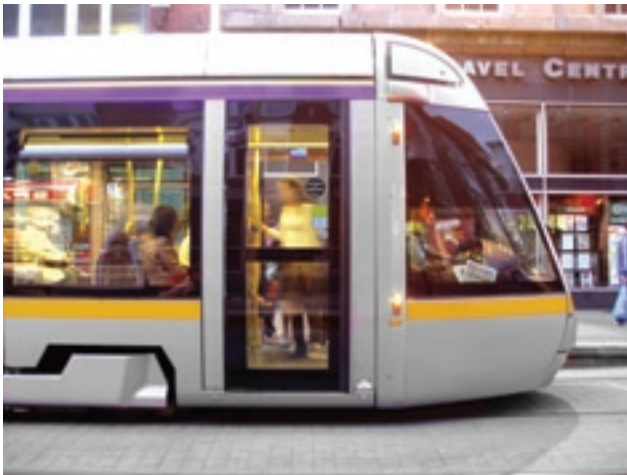
Wyprodukowane przez Alstom tramwaje Citadis są dwukierunkowe, dwustronne i w pełni niskopodłogowe (AB)
