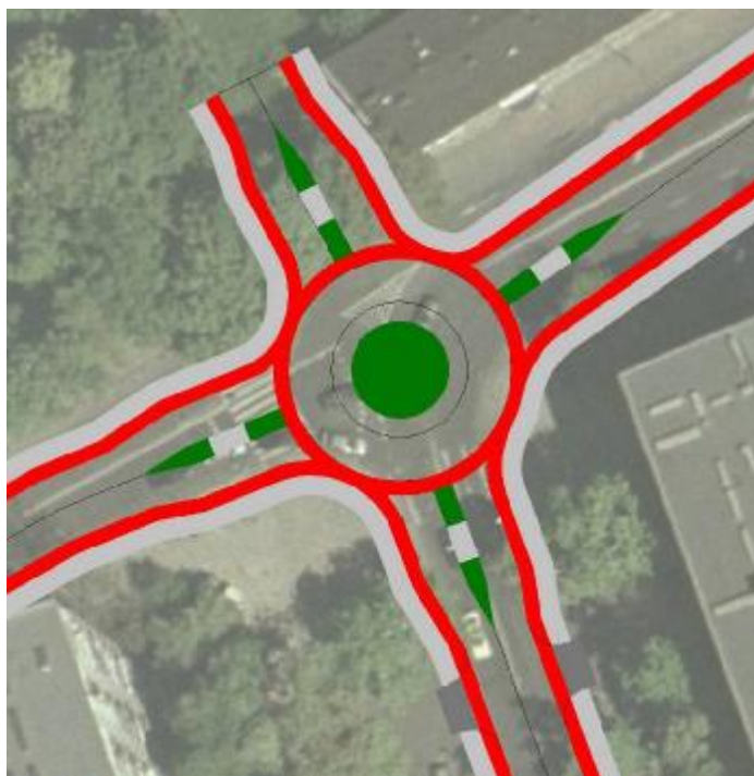
Rys. 19 Schemat rozwiązania ronda z ruchem rowerowym prowadzonym po obwiedni.
