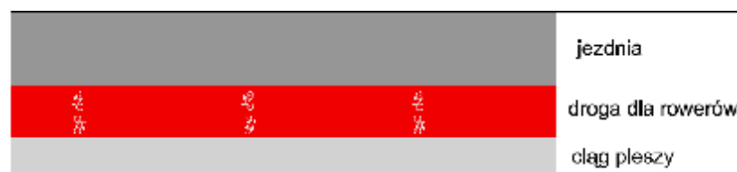
Rys. 7 Przykład usytuowania drogi dla rowerów, nie oddzielonej (zarówno od ruchu samochodowego jak i pieszego).
